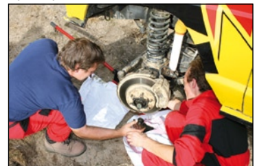
I to patří k závodům. Tomáš Janků s Petrem Lukešem (399) vyměňovali kloub v polních podmínkách přímo na závoděšti
